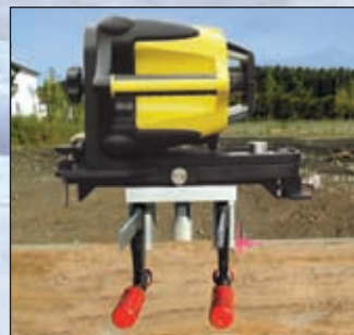
RUGBY 200 con staffa di fissaggio collocata su una stadia
